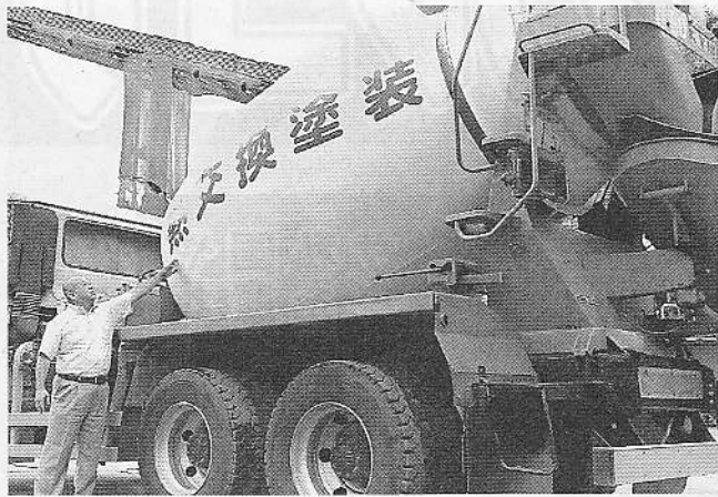
熱交換塗料を塗ったミキサー車—静岡市
